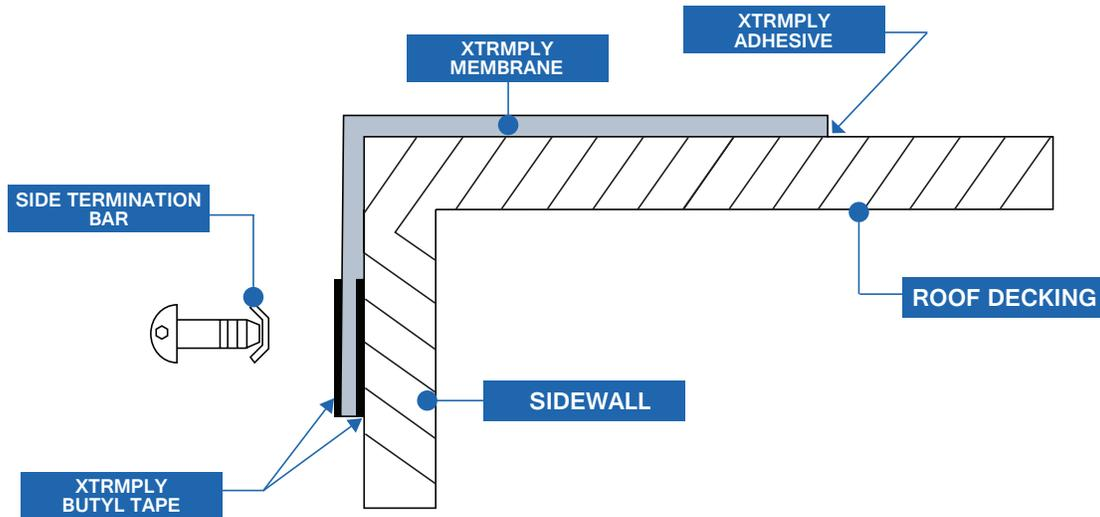
**SIDEWALL CORNER CAPS TERMINATION RAILS INSTALLATION**
